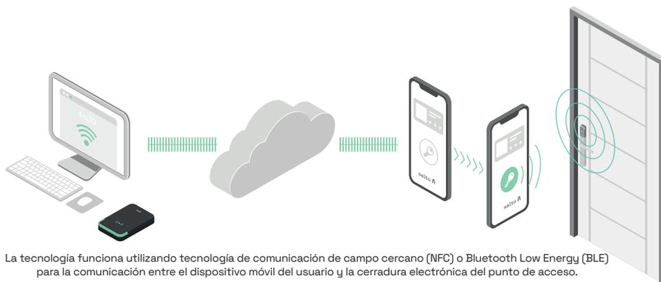
La tecnología funciona utilizando tecnología de comunicación de campo cercano (NFC) o Bluetooth Low Energy (BLE) para la comunicación entre el dispositivo móvil del usuario y la cerradura electrónica del punto de acceso.
